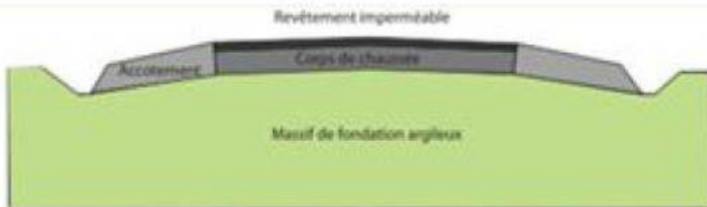
a. Profil théorique initial (argile à teneur en eau initiale, moyenne)
